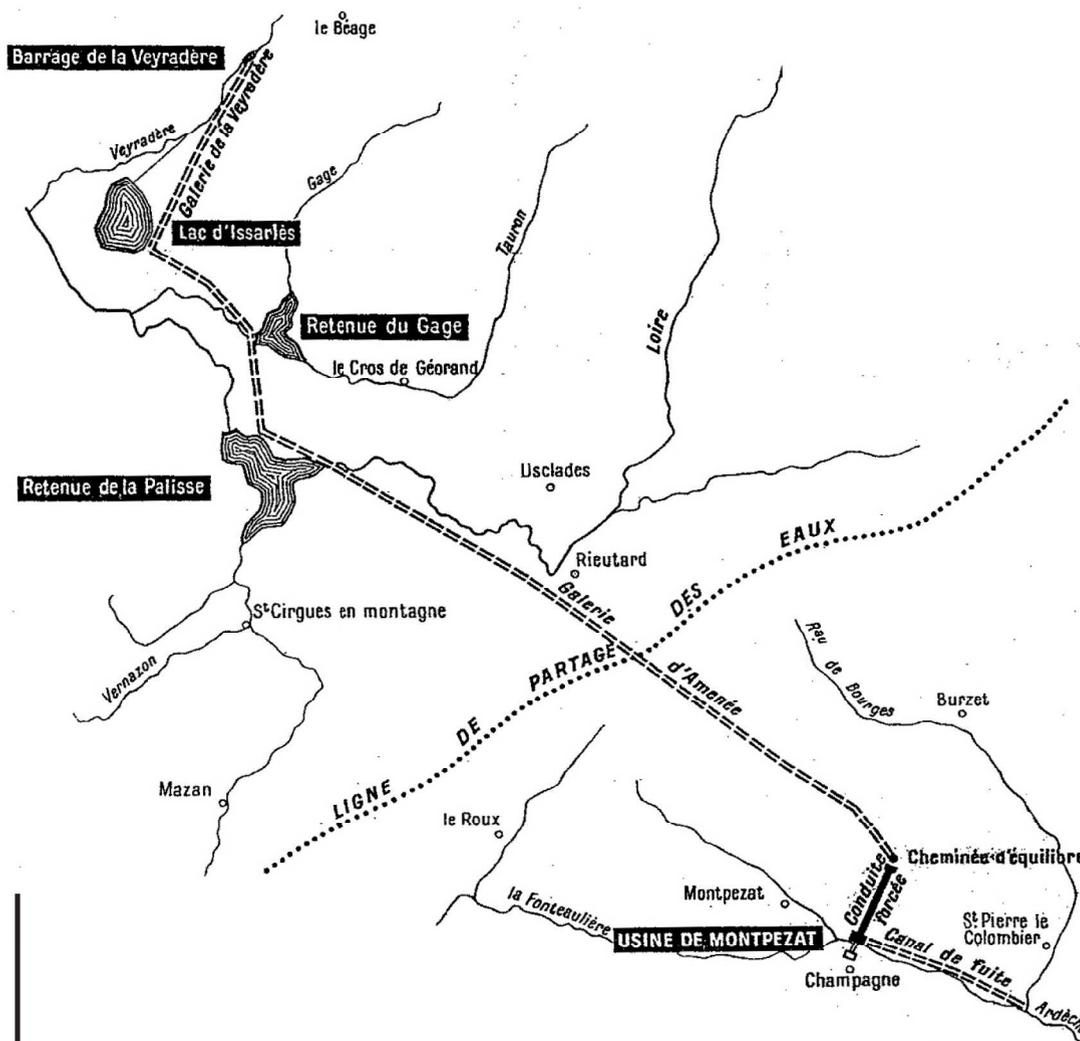
Schéma en plan des aménagements hydro-électriques Issarlès-Montpezat
